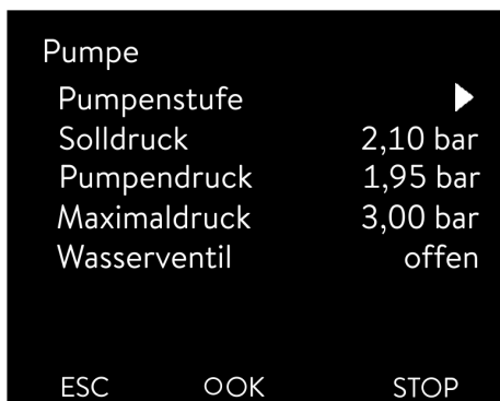
Abb. 29: Menü Pumpe bei Integral IN XT
